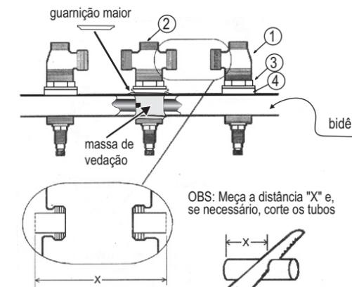
Ainda com os laterais e central colocados sobre o bidê, monte os tubos, conforme indicado no desenho ao lado.
