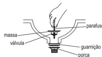
4 Aperte o parafuso, utilizando uma chave de fenda adequada.
