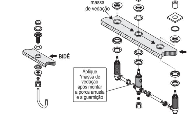
**Dica:** Para maior facilidade na instalação, antes de instalar a duchinha e a ligação, instale a válvula de escoamento, conforme instruções no verso deste folheto.
