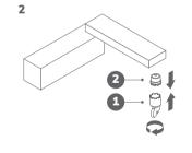
Lave o arejador em água corrente Wash the aerator under running water Lavar el aireador con agua corriente
