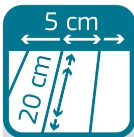
Atenção às dimensões mínimas de régua a serem respeitadas na instalação.
